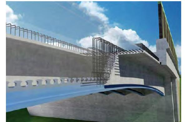
Visualisierung der PreCoBeam-Bauweise
