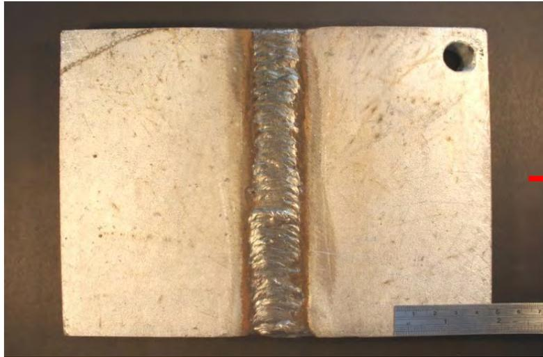
Sandstrahlen der Schweißnaht
