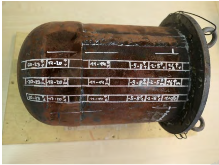
Abbn. 23 + 24: Stahlkessel nach dem Langzeitversuch mit angezeigten Entnahmestellen für die Schliifproben im regelmäßig eingefrorenen Bereich (linkes Bild) und im nie eingefrorenen Referenzbereich (mittleres Bild)
