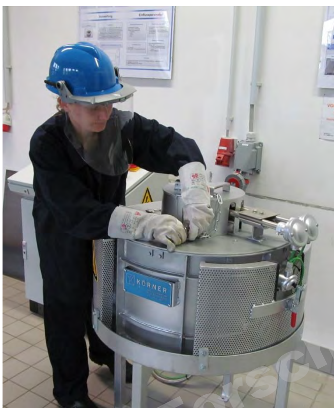
Abbn. 6 – 8: Forschungs-Verzinkungskessel des IKS Dresden Hersteller: Zink Körner, Fassungsvermögen des Korund-Mullit-Tiegels: ca. 30 kg Zink
