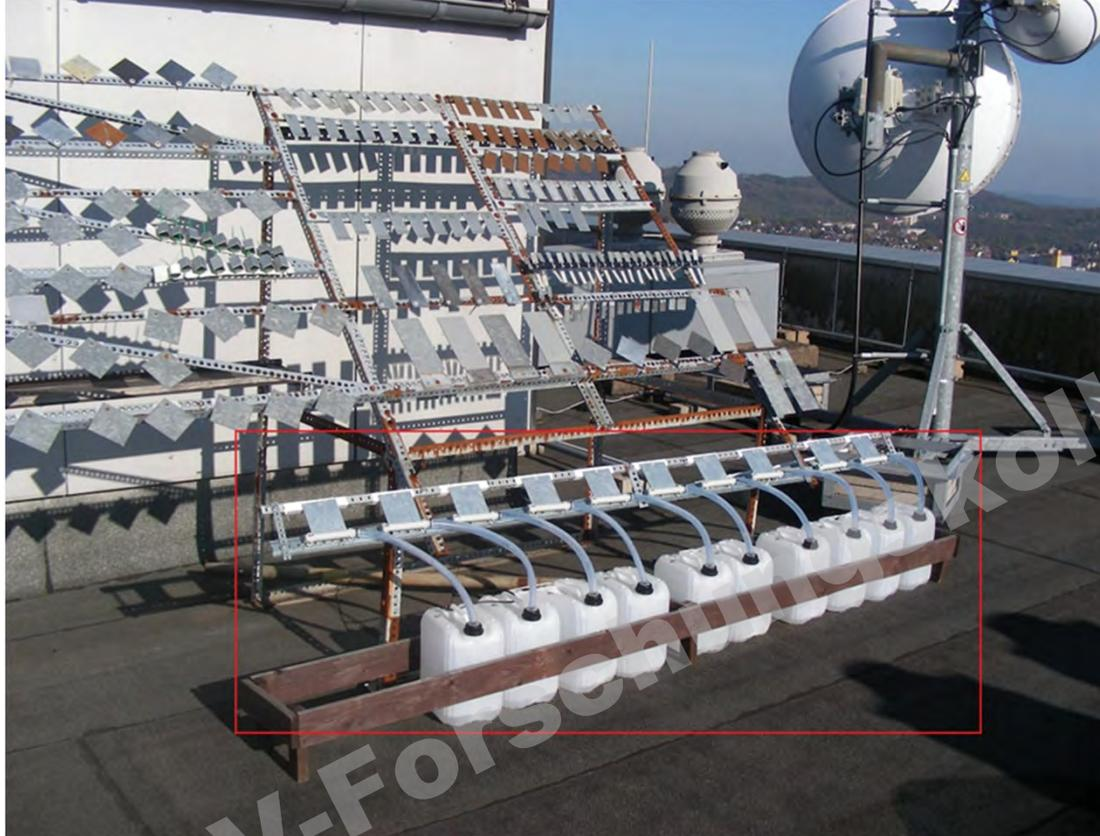
**100x100x4 mm Stahlproben aus dem Niedrigsilizium-Bereich verzinkt in Schmelze 17Cr0.4 mit Verzinkungszeiten von 5 min und 10 min bei einer Verzinkungstemperatur von 450° C. Standort ist der Freibewitterungsstand mit der Auffangvorrichtung für Regenwasser auf dem Dach der FH Südwestfalen in Iserlohn. Start der Auslagerung: 16. September 2019 (rotes Rechteck)**
