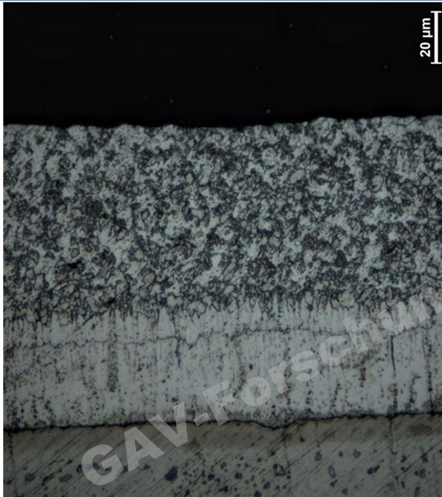
Dicke und dichte Delta1-Phase sowie kompakte Zeta-Phase auf einem Sebisty-Stahl. Aufbau unabhängig vom Si-Gehalt des Stahls.
